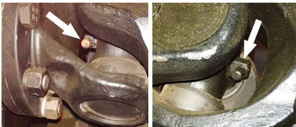
Рисунок 5.58. Расположение пресс-масленок на крестовине карданного вала
