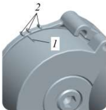
Рисунок 5.23. Процедура проверки натяжения ремня
