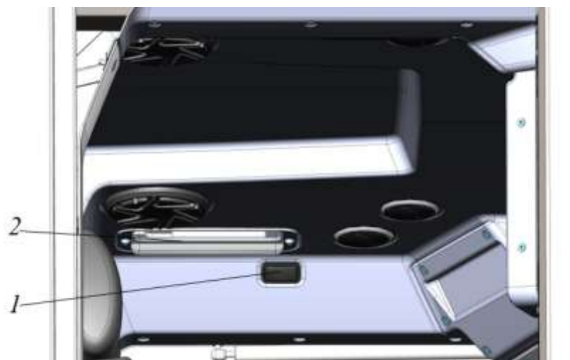
Рисунок 3. 32 Освещение кабины оператора
