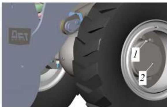
Рисунок 5.55. Замена масла в переднем мосту
