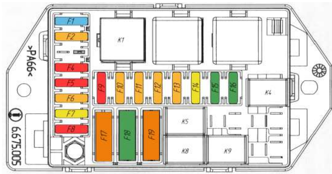
Рисунок 4.6. Расположение предохранителей и реле в лючке противовеса
