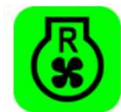
Рисунок 5.35. Индикатор реверсного режима работы вентилятора
