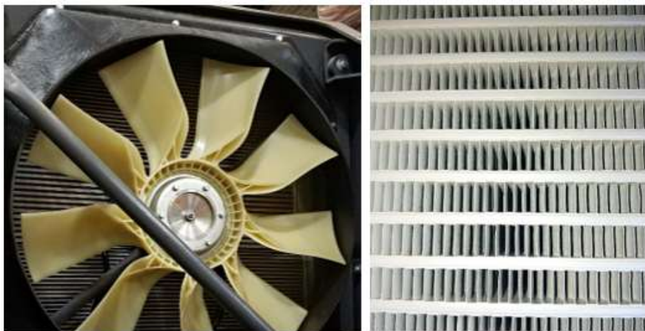
Рисунок 5.36. Осмотр и чистка сот блока радиаторов
