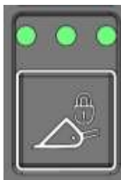
Рисунок 3. 61 Кнопка блокировки гидросистемы привода рабочего оборудования
