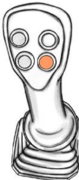
Рисунок 3.42 Кнопка отключения коробки передач
