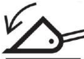
Рисунок 3.31 Переключатель автоматического возврата к режиму копания
