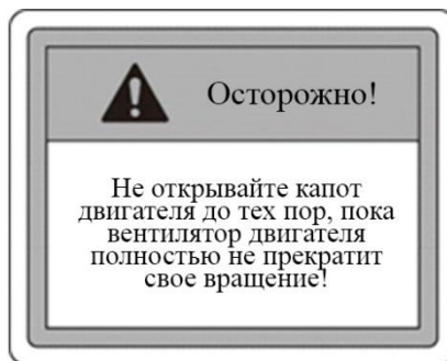
Рисунок 2. 34. Знак предупреждения на вентиляторе двигателя
