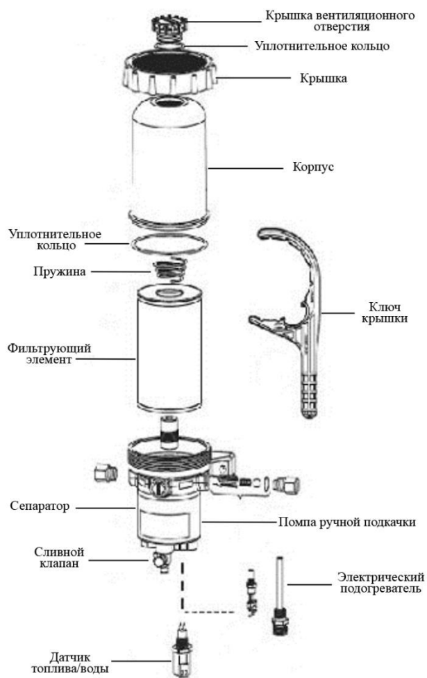
Рисунок 5. 35. Топливный фильтр в разборе
