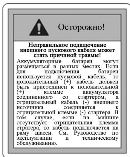
Рисунок 2. 26. Неправильное подключение внешнего пускового кабеля
