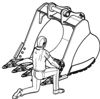
Рисунок 5. 12. Замена ножей ковша
