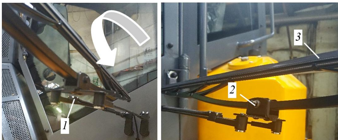
Рисунок 3.26. Замена щетки стеклоочистителя
