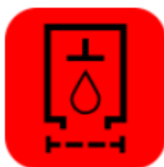
Рисунок 5.52. Индикатор фильтра во всасывающей линии
