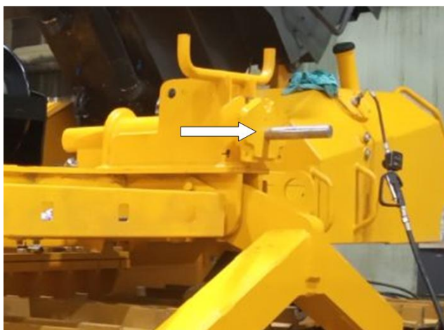
Рисунок 3.76. Механизм ограничения максимального угла наклона стрелы
