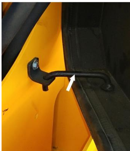
Рисунок 5.32. Фиксация рамы вентилятора в открытом положении (стрелками показано место расположение упора)
