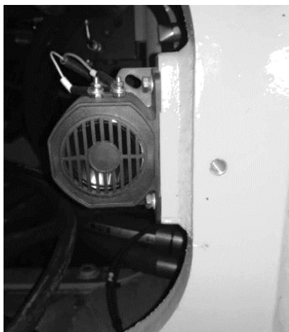
Рисунок 3.48. Гудок предупредительной сигнализации о движении задним ходом (задний щиток снят)
