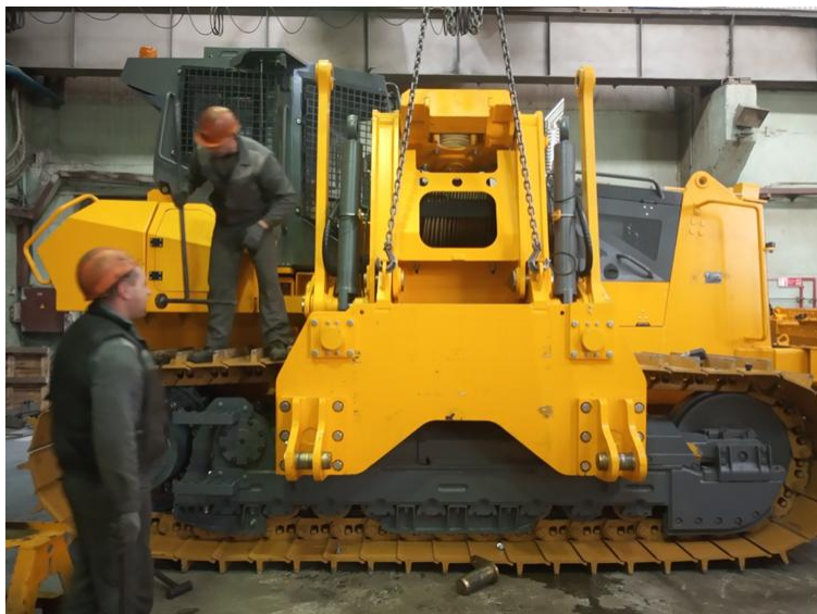
Рисунок 3.70. Установка опоры контргруза
