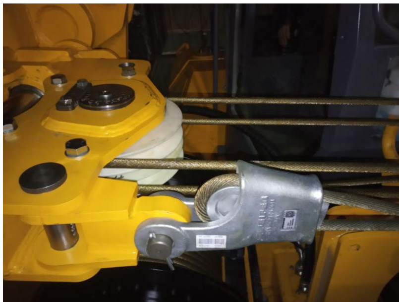
Рисунок 3.89. Клиновидная втулка на блоке лебедок
