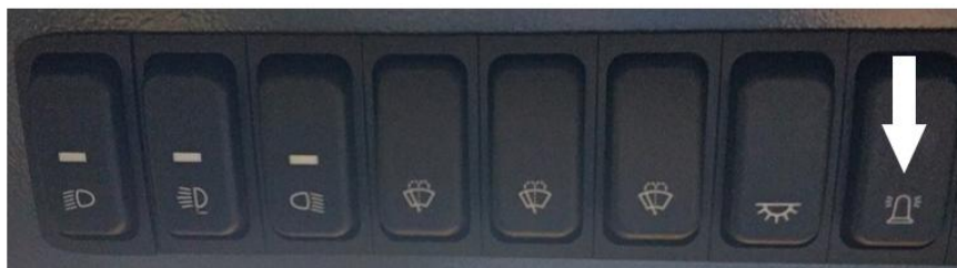
Рисунок 3.50. Включение проблескового маяка (клавиша показана стрелкой)
