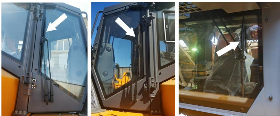
Рисунок 3.24. Размещение щеток стеклоочистителя на окнах кабины
