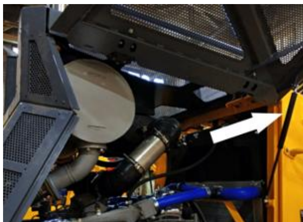
Рисунок 3.17. Газовый упор створки капота показан стрелкой
