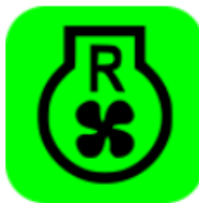
Рисунок 5.33. Индикатор реверсного режима работы вентилятора
