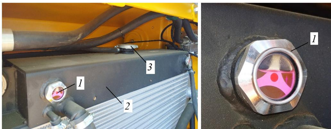
Рисунок 5.29. Расширительный бачок жидкостной системы охлаждения двигателя 1 – смотровое окно расширительного бачка; 2 – расширительный бачок; 3 – крышка наливной горловины
