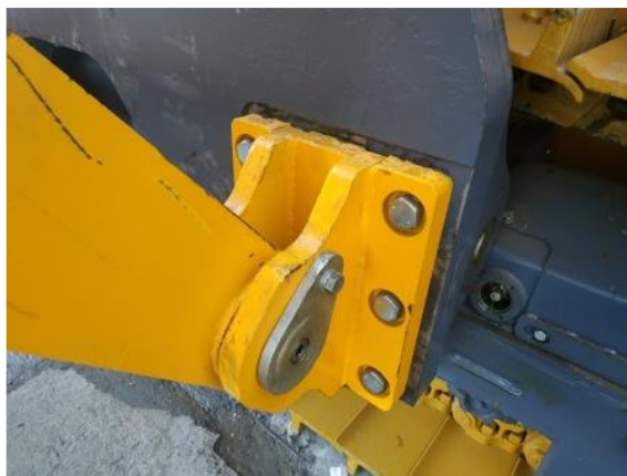
Рисунок 3.59. Крепление опоры и рычага контргруза
