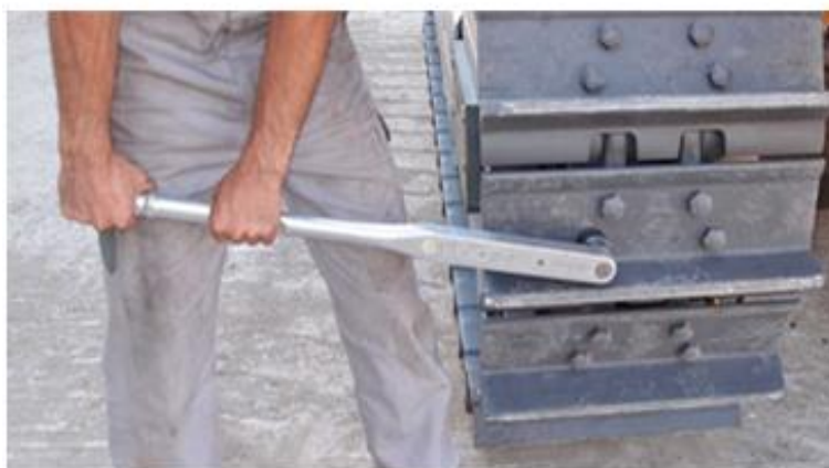
Рисунок 5.73. Проверка затяжки крепежа башмаков звеньев гусеницы
