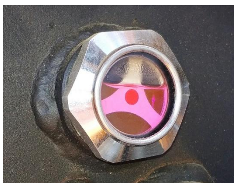
Рисунок 5.40. Смотровое окно расширительного бачка (проверка уровня охлаждающей жидкости в системе охлаждения)
