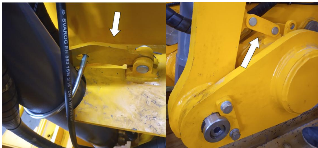
Рисунок 3.81. Демонтаж креплений гидроцилиндров и тяг
