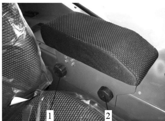
Рисунок 3.34. Регулировка подлокотников 1 и 2 – винты регулировки подлокотника
