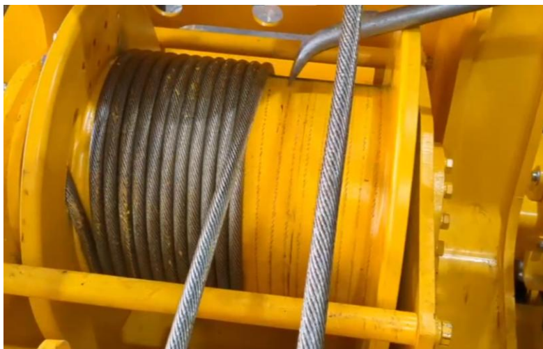
Рисунок 4. Намотка и укладка каната
