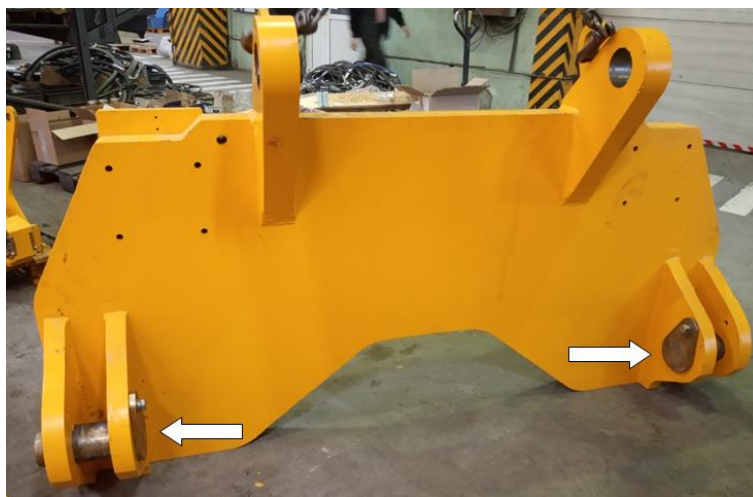
Рисунок 3.68. Установка опоры контргруза
