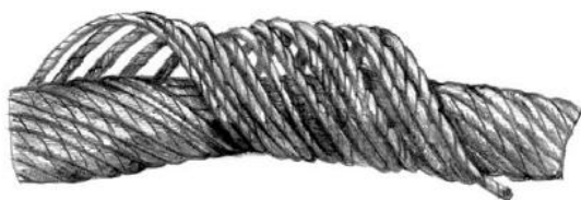
Корзинообразная деформация каната
