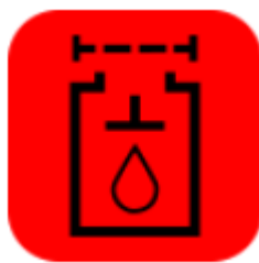
Рисунок 5.49. Индикатор фильтра в сливной линии
