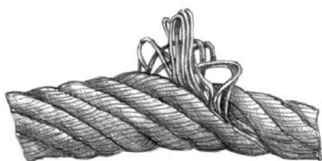
Корзинообразная деформация каната
