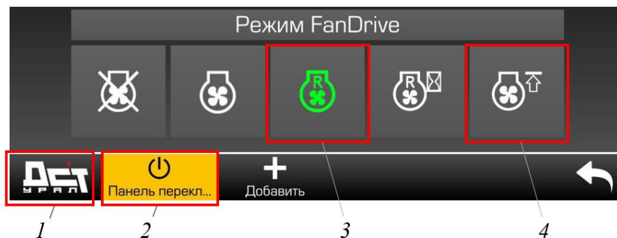
Рисунок 5.36. Активация реверсного режима работы вентилятора
