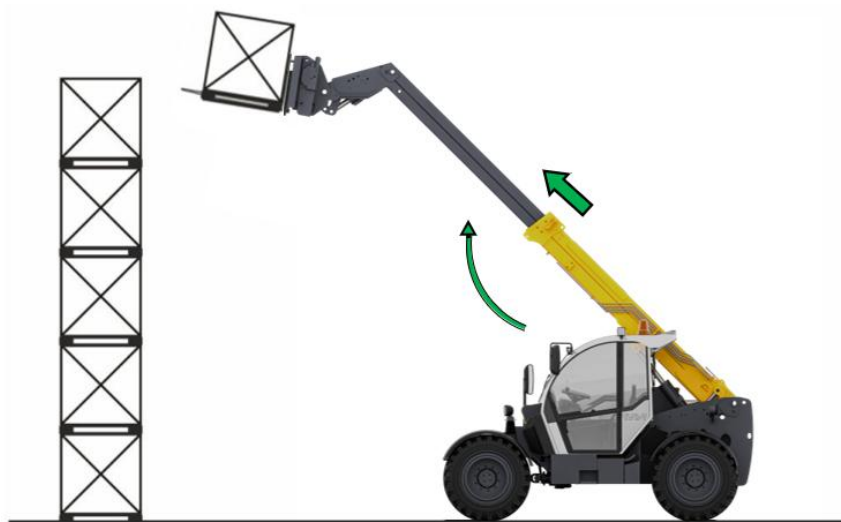
Рисунок 3.114. Подъем груза на необходимую высоту
