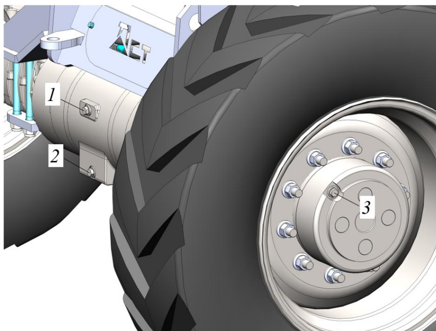
Рисунок 5.61 Замена масла в переднем мосту
