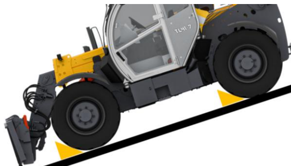
Рисунок 3.88. Установка противооткатных упоров
