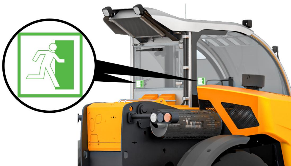
Рисунок 3.32. Расположение аварийных выходов
