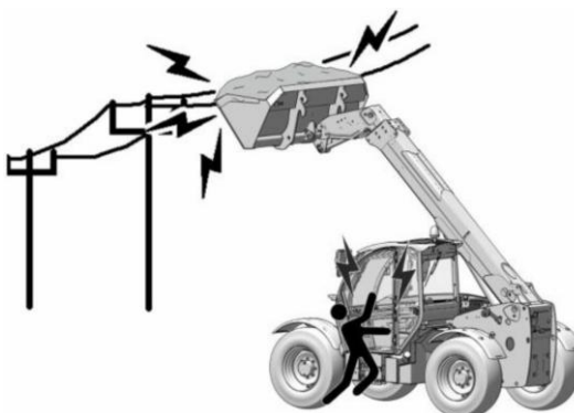
Рисунок 3.104. Работа вблизи воздушных линий электропередач
