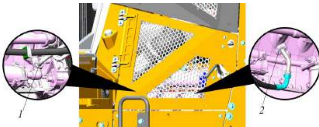
Рисунок 5.86. Соединение ПЖД с двигателем
