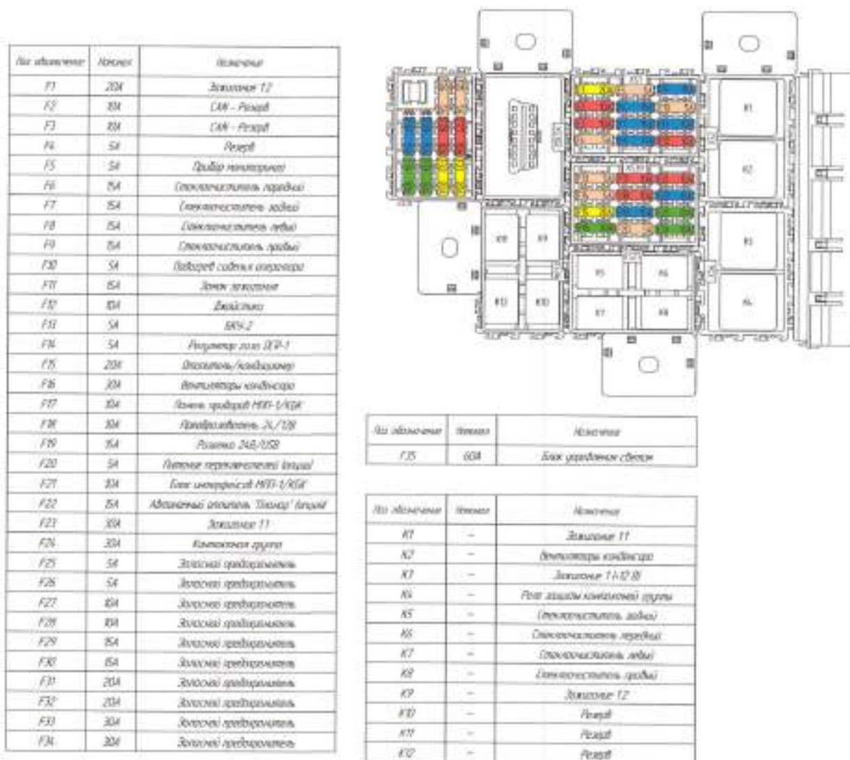
Рисунок 4.1. Блок предохранителей и реле
