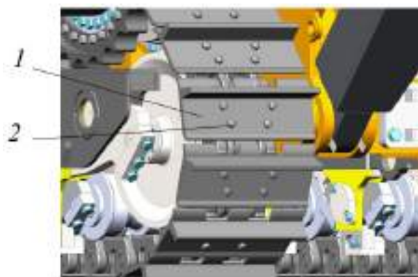
Рисунок 5.159. Проверка затяжки крепежа звеньев гусеницы
