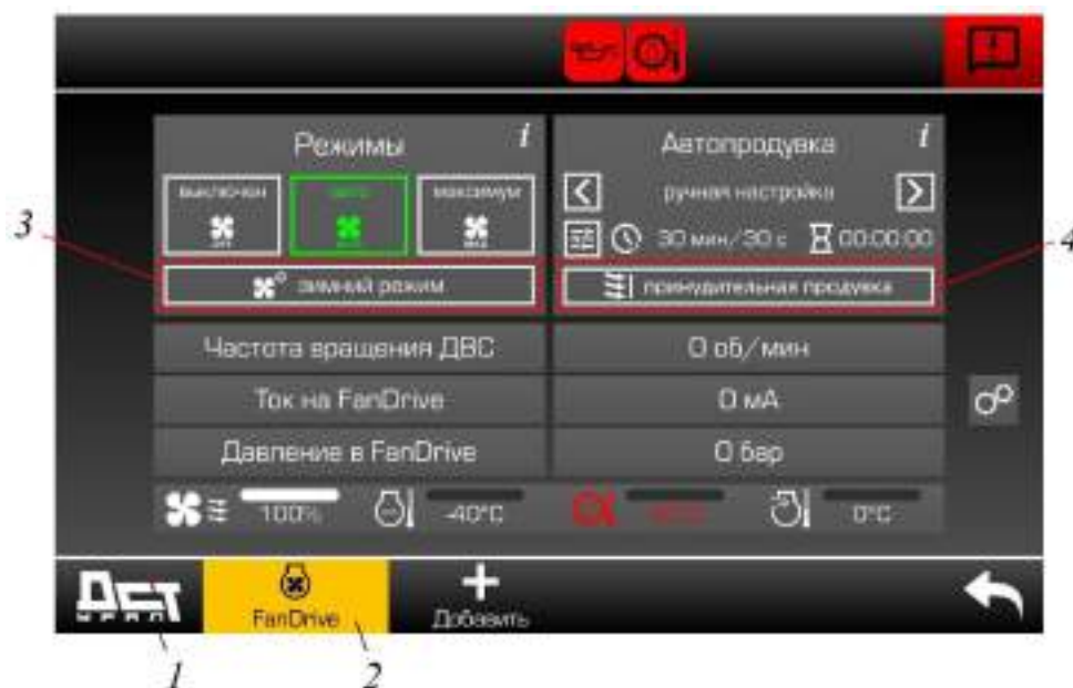
Рисунок 5.78. Активация реверсного режима работы вентилятора
