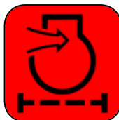
Рисунок 5.67. «Засор воздушного фильтра двигателя»
