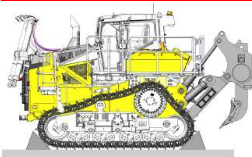
Рисунок 3.159. Установка противооткатных упоров под гусеницы
