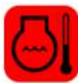
Рисунок 3.60. Индикатор «Высокая температура охлаждающей жидкости»
