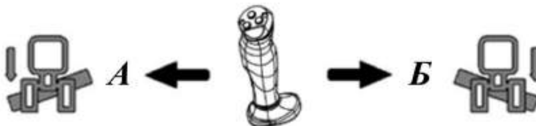
Рисунок 3.99. Приведение в действие гидроцилиндра перекоса отвала
