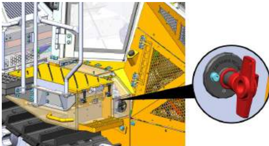
Рисунок 3.62. Главный выключатель аккумуляторной батареи («+»)
