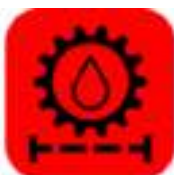
Рисунок 5.105. Индикатор «Засор фильтра трансмиссии»
