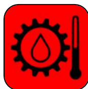
Рисунок 3.61. Индикатор «Высокая температура масла в трансмиссии»
