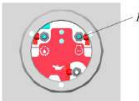
Рисунок 5.82. Кран слива охлаждающей жидкости
