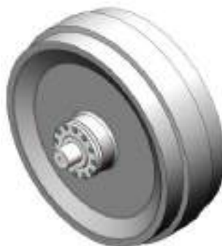
Рисунок 5.160. Внешний осмотр натяжного колеса
