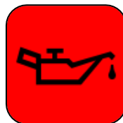
Рисунок 5.55. Индикатор «Низкое давление масла в двигателе»
