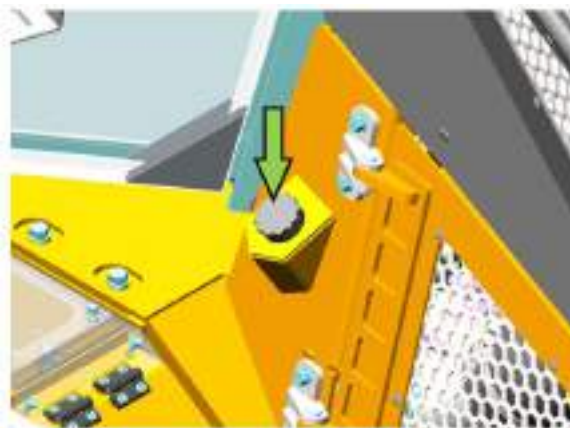
Рисунок 5.114. Место расположения маслоналивной горловины раздаточной коробки
