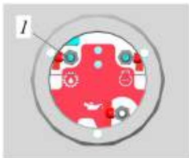
Рисунок 5.116. Кран слива трансмиссионного масла
