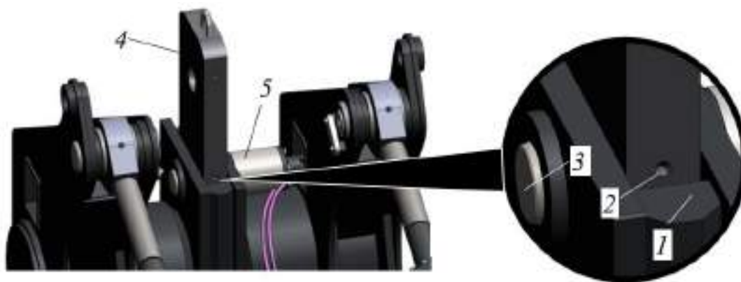
Рисунок 3.149. Фиксация ножа в гнезде рыхлителя
