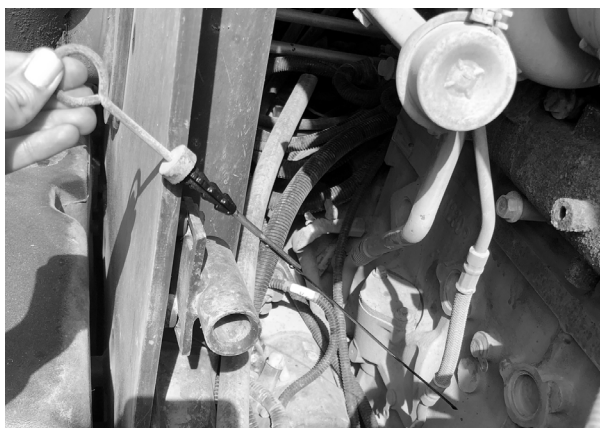
Рисунок 5.3 Проверка уровня моторного масла
