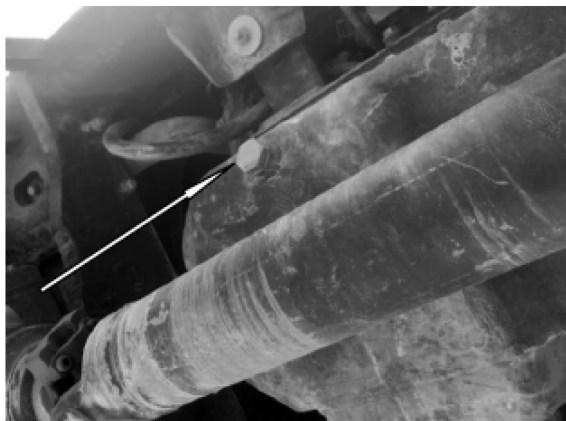
Рисунок 5.4 Сливная пробка двигателя
