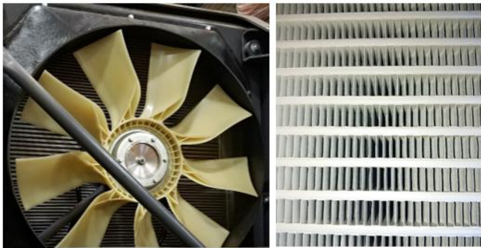
Рисунок 5.39. Осмотр и чистка сот блока радиаторов
