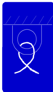
Рисунок 2.16. Табличка Точка крепления
