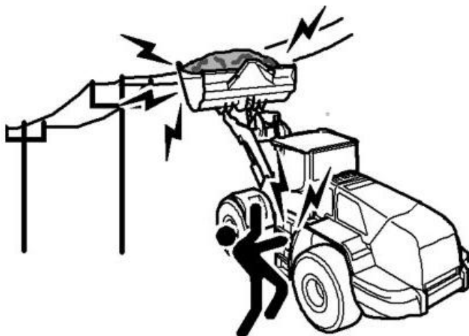
Рисунок 3.86. Работа вблизи воздушных линий электропередач
