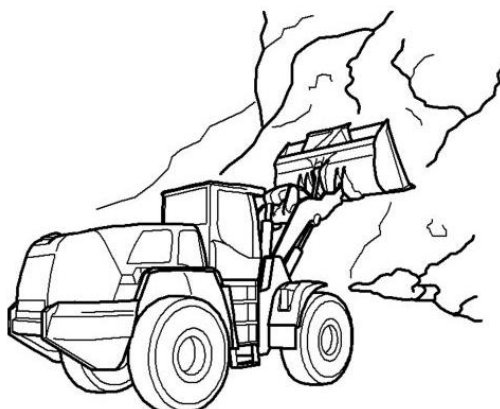
Рисунок 3.83. Процесс отбора материала сверху вниз
