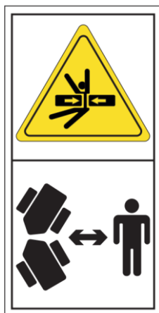
Рисунок 2.3. Табличка Зона излома рамы
