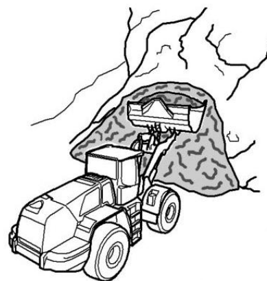
Рисунок 3.83. Процесс отбора материала сверху вниз
