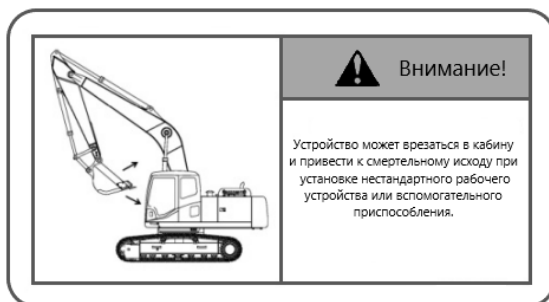
Рисунок 2.6 Предупредительная табличка о повреждении ковшом кабины
