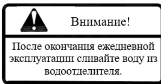
Рисунок 2.15 Слив воды из водоотделителя
