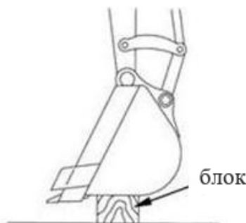
Рисунок 5. 19 Установка блока под зубья ковша
