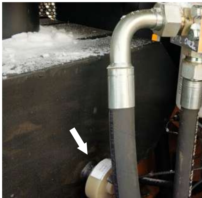
Рисунок 5.38. Датчик засоренности воздушного фильтра
