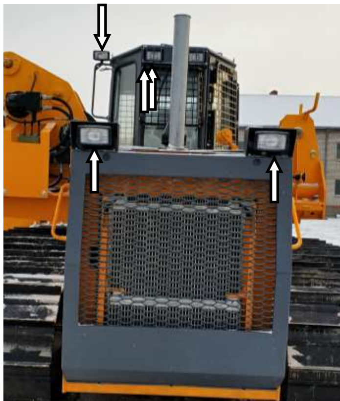
Рисунок 3.31. Расположение прожекторов передней части машины
