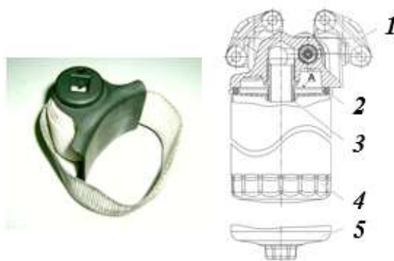
Рисунок 5.9. Замена фильтрующего элемента
