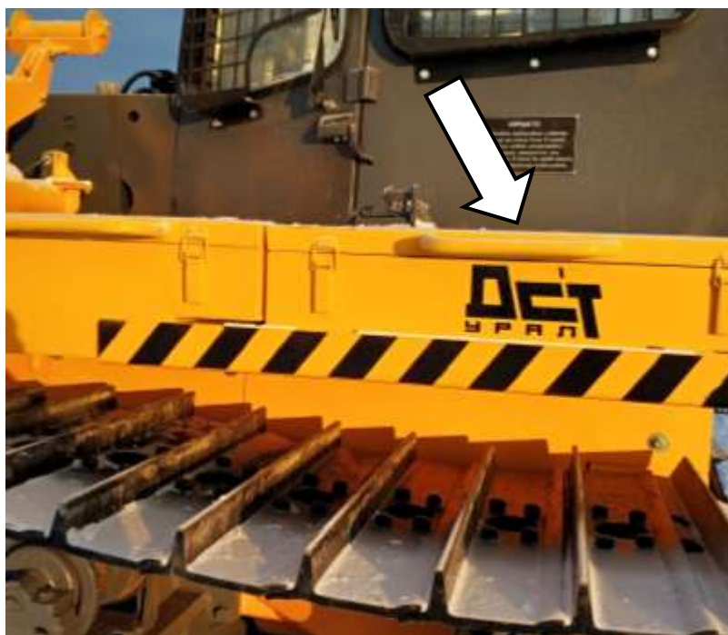
Рисунок 5.46. Ящик с аккумуляторными батареями
