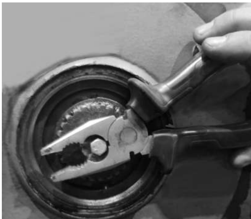
Рисунок 3.60. Снятие шлицевого вала редуктора
