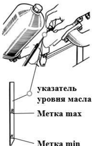
Рисунок 5.7. Контроль уровня масла по масляному щупу
