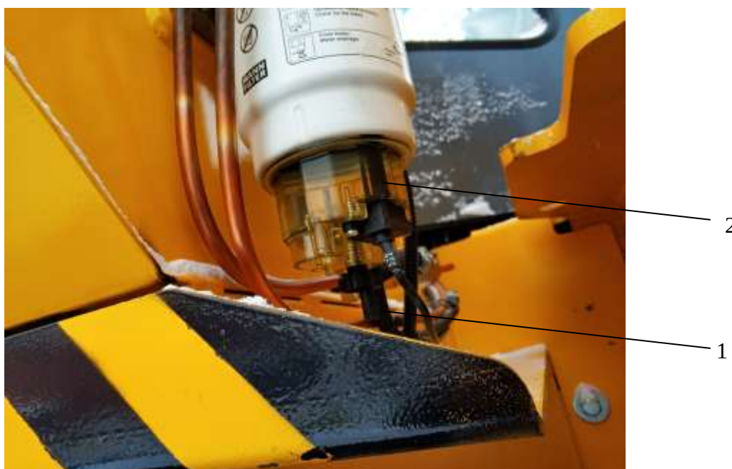
Рисунок 5.27. Топливный фильтр с водосборным стаканом в сборе
