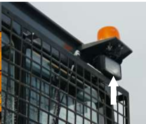
Рисунок 3.34. Расположение прожекторов в задней части машины справа, возле маяка
