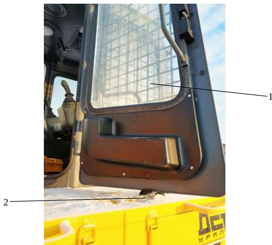
Рисунок 3.15. Разблокировка фиксатора двери
