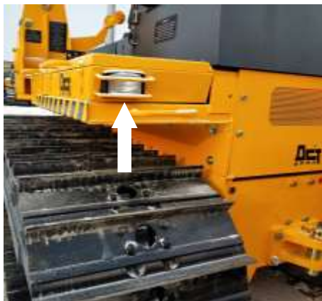
Рисунок 3.33. Расположение прожекторов в задней части машины слева, возле поручня
