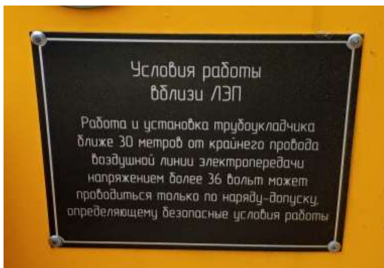
Рисунок 2.2. Условия работы в близи ЛЭП»
