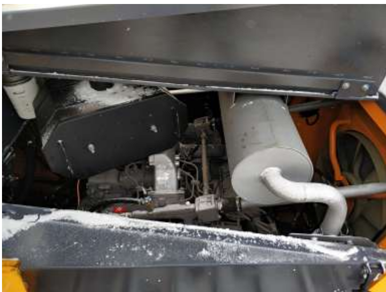
Рисунок 5.20. Впускные и выпускные трубопроводы (правая створка капота)
