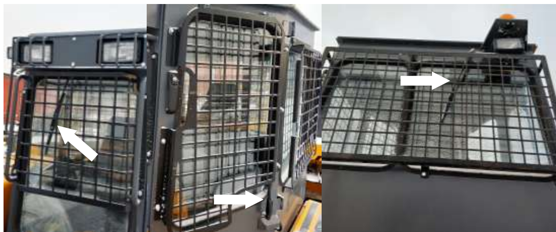
Рисунок 5.6. Размещение щеток стеклоочистителя на окнах кабины
