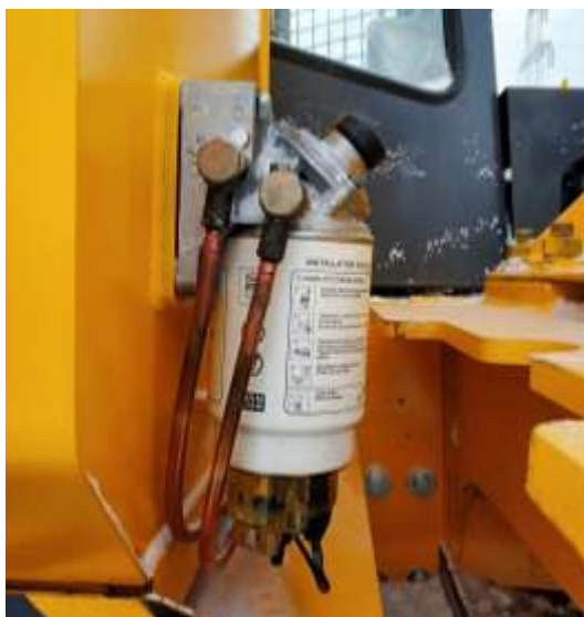
Рисунок 5.29. Топливный фильтр грубой очистки в сборе
