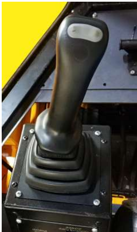
Рисунок 3.51. Рычаг управления гусеничным ходом в нейтральном положении
