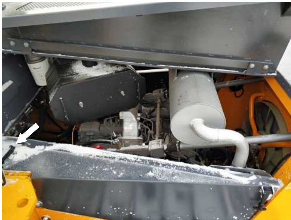
Рисунок 5.4. Механический упор створки капота
