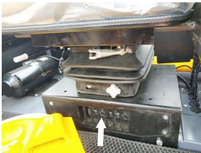
Рисунок 3.21. Радиатор системы охлаждения двигателя (отопитель кабины)
