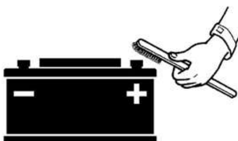
Рисунок 5.48. Специальные щетки для очистки полюсных выводов
