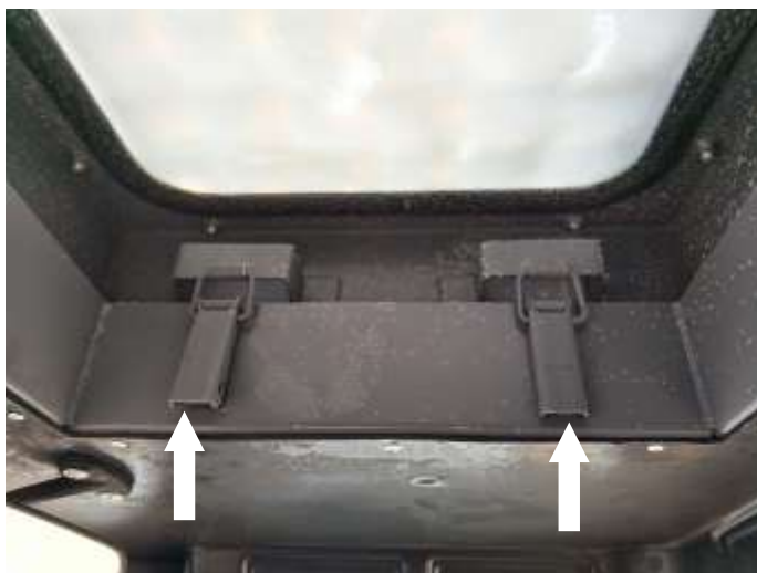
Рисунок 3.12. Открытие аварийного люка
