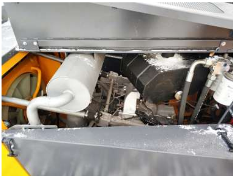
Рисунок 5.21. Впускные и выпускные трубопроводы (левая створка капота)
