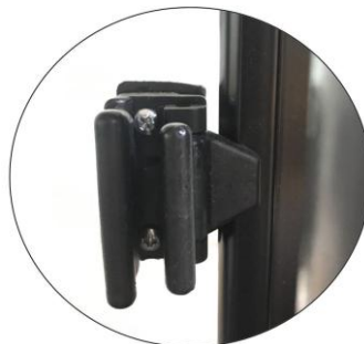
Рисунок 3.14. Открытие окон кабины оператора
