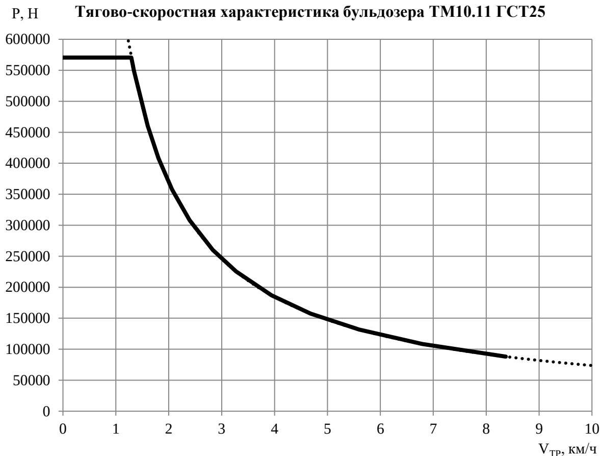
Рисунок 1.4. График тягово-скоростной характеристики ТМ10.11 ГСТ25
