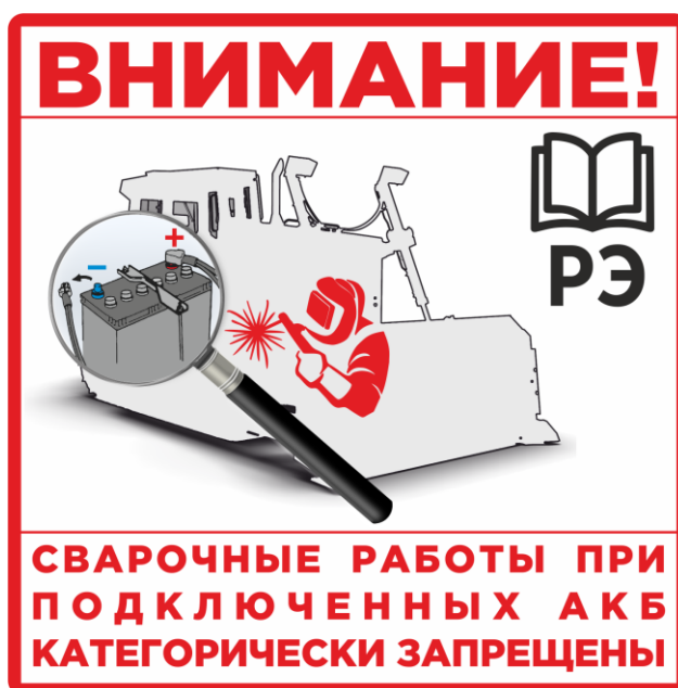
Рисунок 2.11. Табличка «Сварочные работы»
