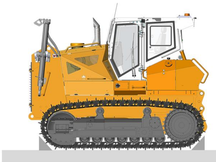
Рисунок 3.134. Установка противооткатных упоров под гусеницы
