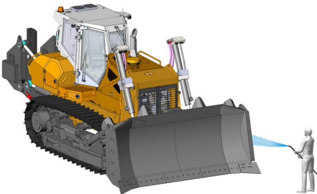
Рисунок 3.46. Процедура мойки машины
