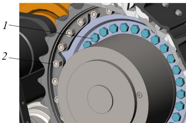
Рисунок 5.68. Проверка крепления редуктора, сегмента и проставки
