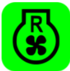
Рисунок 5.35. Индикатор реверсного режима работы вентилятора
