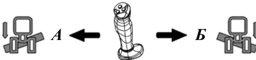
Рисунок 3.102. Приведение в действие гидроцилиндра перекоса отвала
