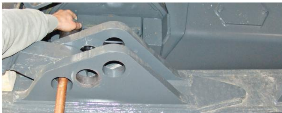
Рисунок 3.101. Центрирование отверстий тяги с толкающим брусом
