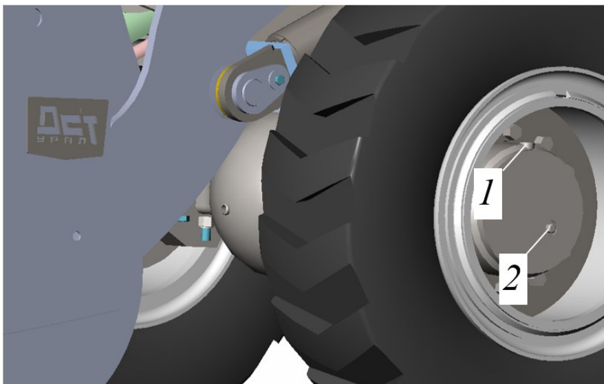
Рисунок 5.55. Замена масла в переднем мосту
