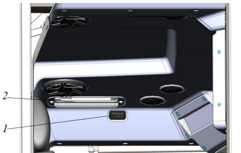
Рисунок 3.30. Освещение кабины оператора
