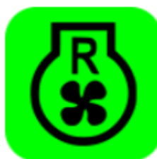
Рисунок 5.35. Индикатор реверсного режима работы вентилятора
