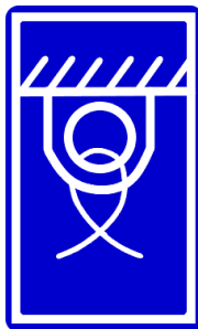
Рисунок 2.13. Табличка «Место крепления буксировочных строп»
