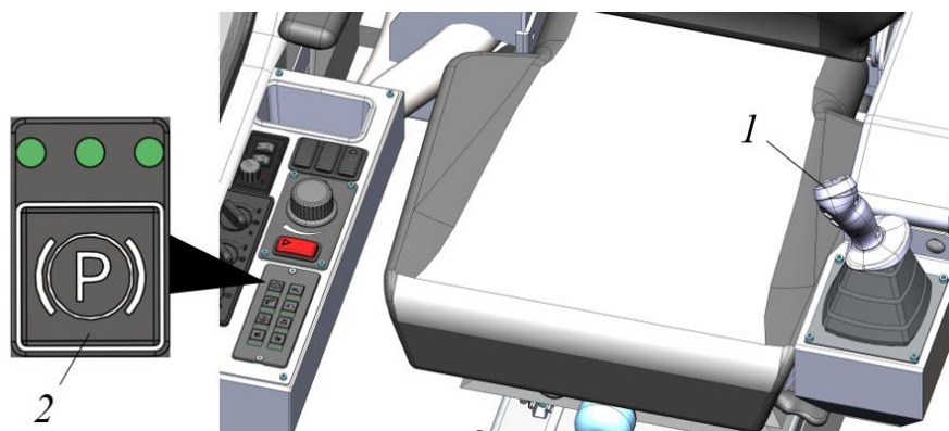
Рисунок 3.52. Органы управления, отвечающие за движение и торможение машины
