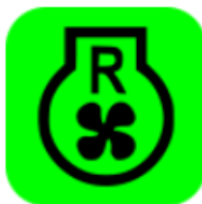
Рисунок 5.23. Индикатор реверсного режима работы вентилятора
