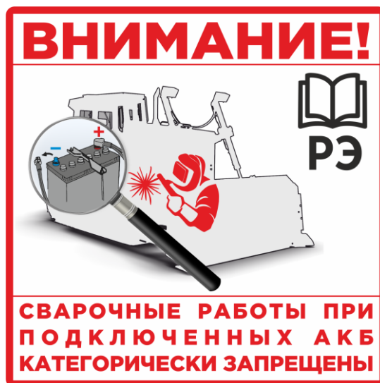
Рисунок 2.9. Табличка «Сварочные работы»
