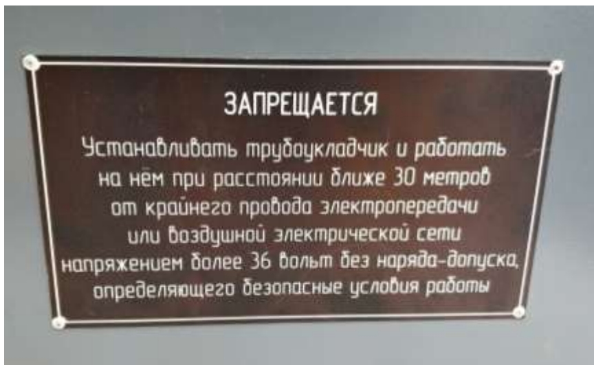
Рисунок 2.3. Табличка «Запрещается размещать трубоукладчик и работать на нем ближе 30 метров от ближайшего провода линии электропередач»
