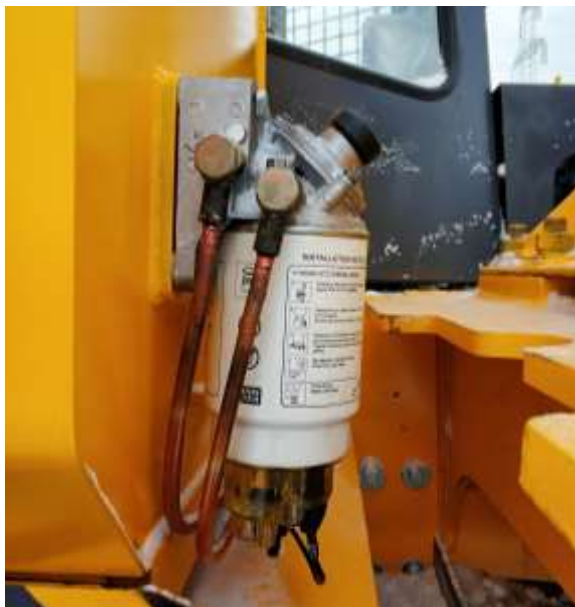
Рисунок 5.29. Топливный фильтр грубой очистки в сборе
