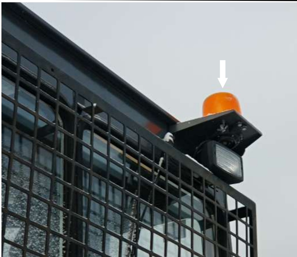
Рисунок 3.30. Расположение проблескового маяка
