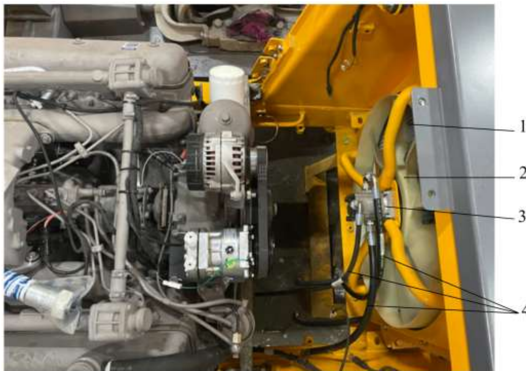
Рисунок 3.22. Система охлаждения FanDrive
