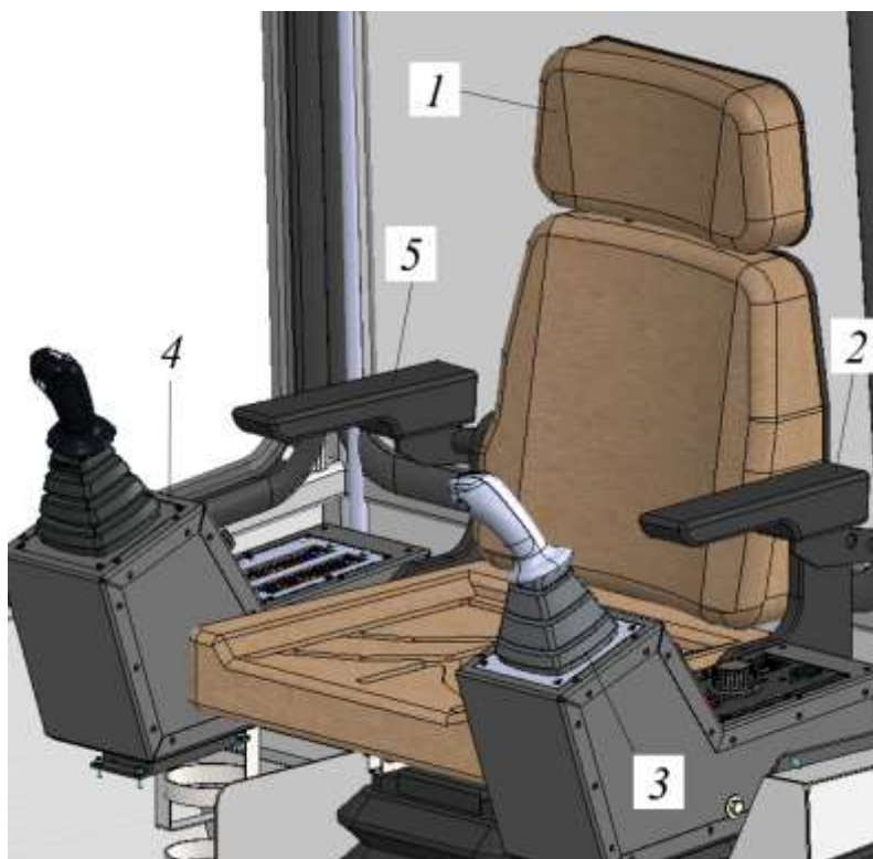
Рисунок 3.16. Сиденье оператора и его размещение в кабине
