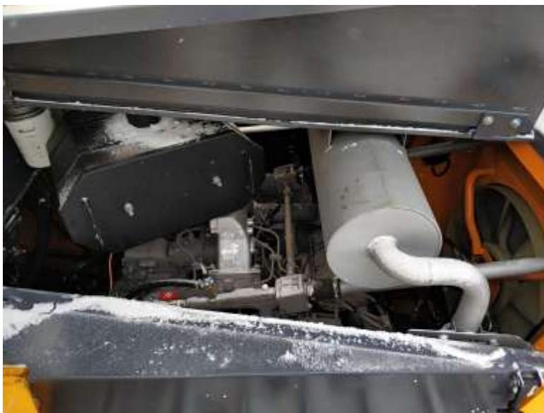
Рисунок 5.20. Впускные и выпускные трубопроводы (правая створка капота)
