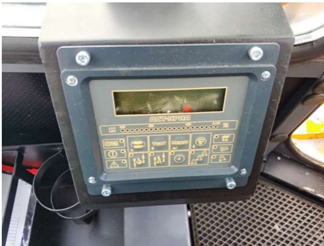
Рис. 3.40. Прибор автоматического ограничения грузоподъемности
