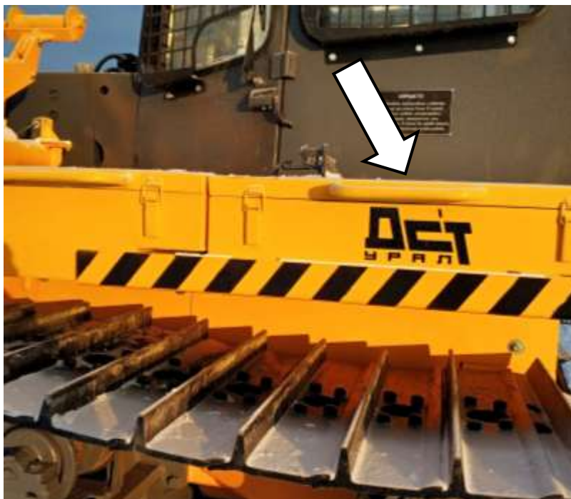
Рисунок 5.46. Ящик с аккумуляторными батареями
