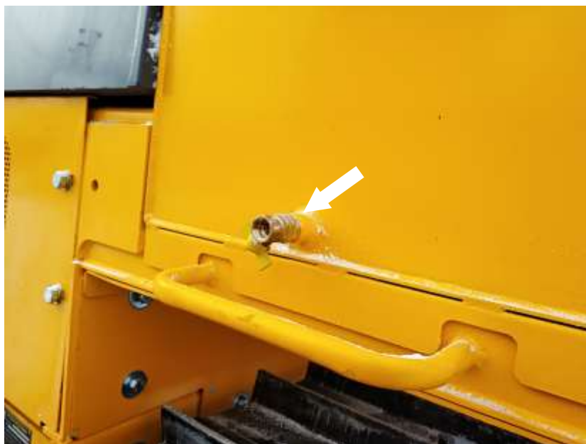
Рисунок 5.28. Запорный кран для слива топлива с бака
