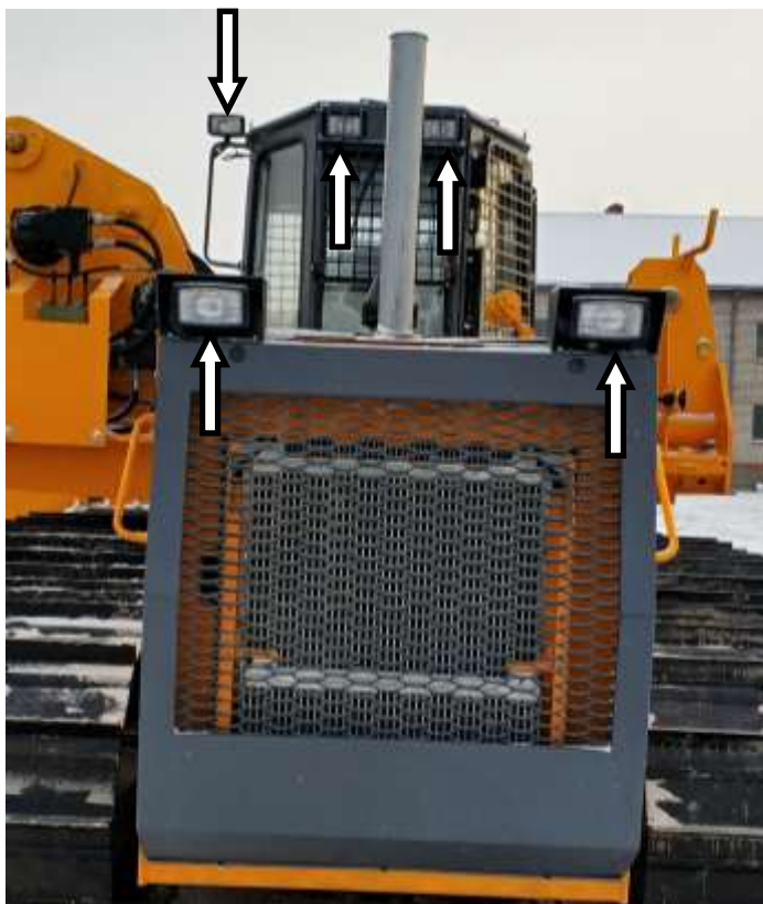
Рисунок 3.31. Расположение прожекторов передней части машины
