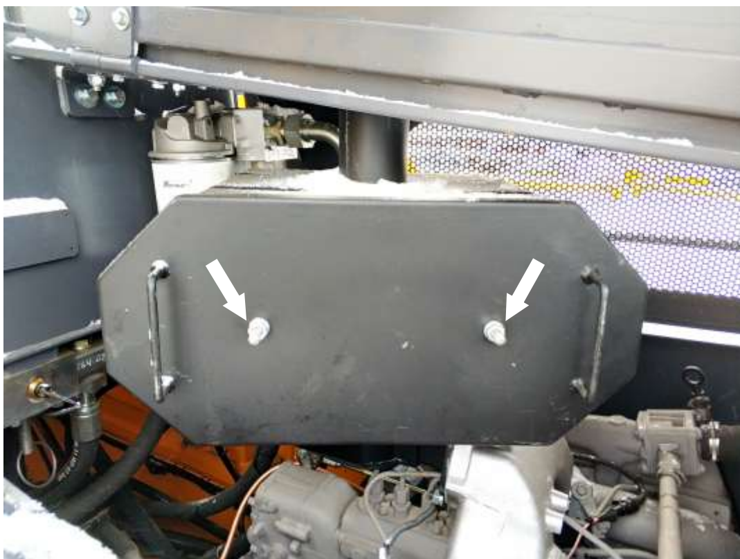
Рисунок 5.37. Корпус воздушного фильтра
