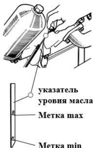
Рисунок 5.7. Контроль уровня масла по масляному щупу
