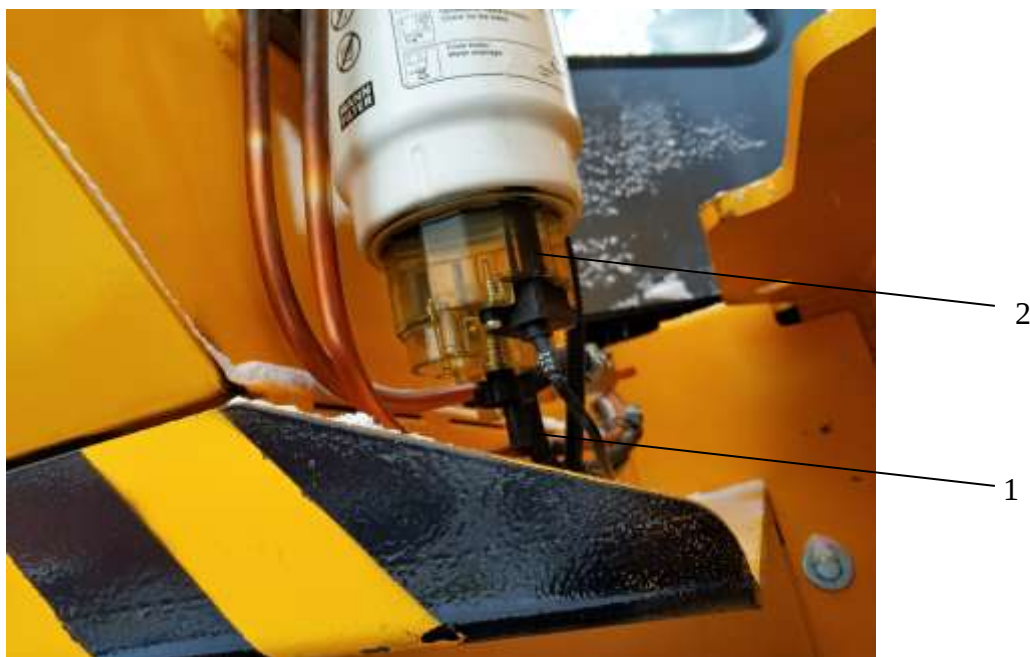
Рисунок 5.27. Топливный фильтр с водосборным стаканом в сборе
