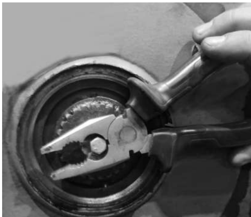
Рисунок 3.60. Снятие шлицевого вала редуктора
