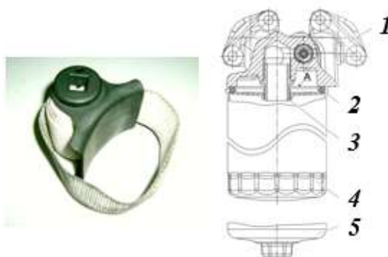
Рисунок 5.9. Замена фильтрующего элемента
