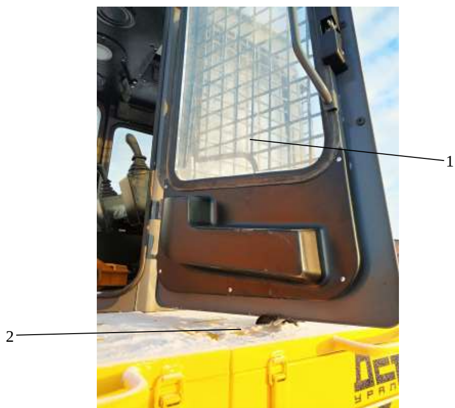
Рисунок 3.15. Разблокировка фиксатора двери
