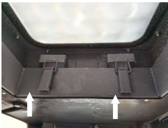
Рисунок 3.12. Открытие аварийного люка
