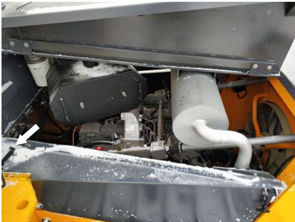
Рисунок 5.4. Механический упор створки капота
