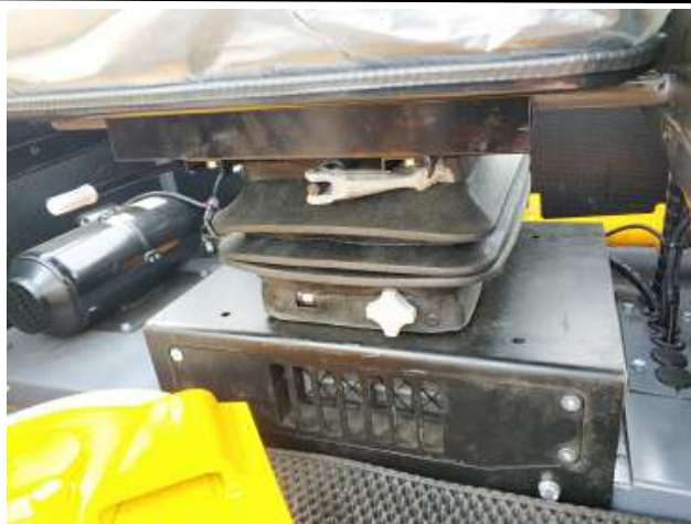
Рисунок 3.21. Радиатор системы охлаждения двигателя (отопитель кабины)
