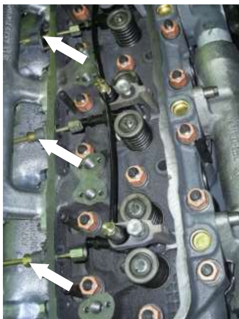
Рисунок 5.35. Соединение трубопровода с корпусом форсунки
