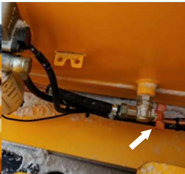
Рисунок 5.30. Кран подачи топлива к фильтру
