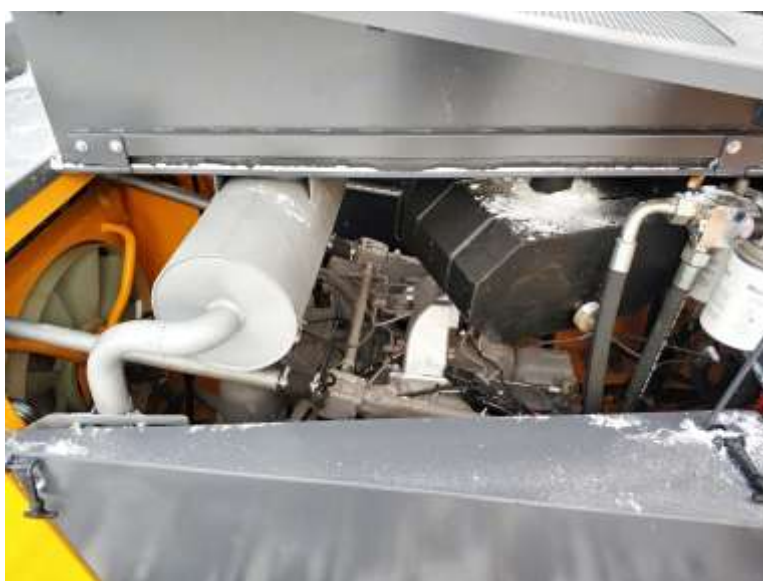
Рисунок 5.21. Впускные и выпускные трубопроводы (левая створка капота)
