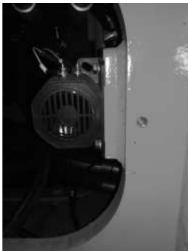
Рисунок 3.29. Гудок предупредительной сигнализации о движении задним ходом (задний щиток снят)
