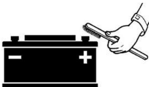
Рисунок 5.48. Специальные щетки для очистки полюсных выводов
