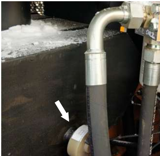
Рисунок 5.38. Датчик засоренности воздушного фильтра
