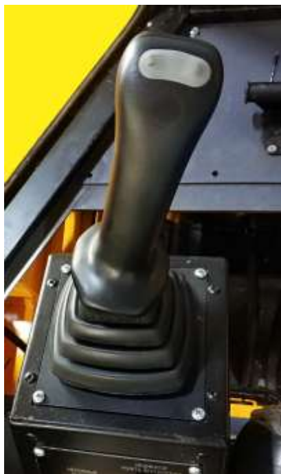
Рисунок 3.51. Рычаг управления гусеничным ходом в нейтральном положении
