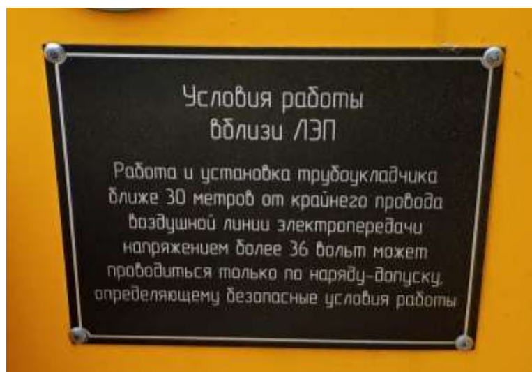
Рисунок 2.2. Условия работы вблизи ЛЭП»
