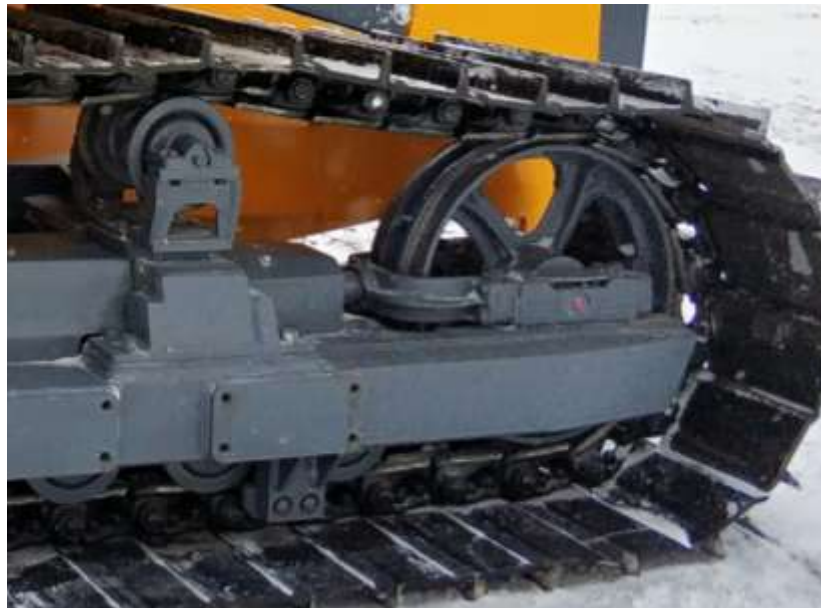
Рисунок 5.54. Направляющая система подвески направляющего колеса
