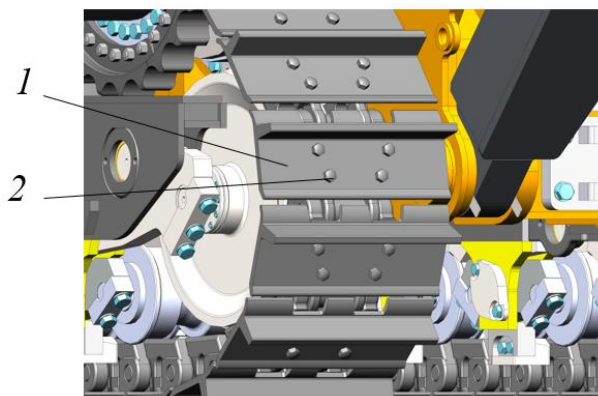
Рисунок 5.150. Проверка затяжки крепежа звеньев гусеницы
