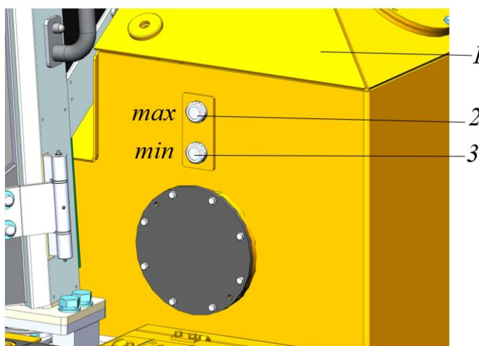
Рисунок 5.88. Проверка уровня масла в гидравлическом баке
